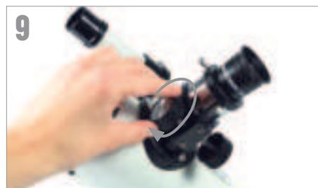
Fokussieren Sie Ihr Teleskop, indem Sie die beiden Knöpfe unter dem Okular drehen, bis Sie ein scharfes Bild haben.
