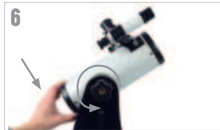
Lösen Sie die Rändelmutter zur Höheneinstellung, indem Sie sie im Uhrzeigersinn drehen und halten die Unterseite des Tubus mit der anderen Hand fest.
