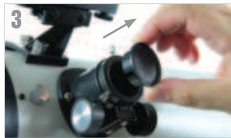
Lösen Sie die Rändelschrauben am Fokussierer und nehmen die Fokussiererkappe ab.
