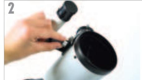
Pour installer le chercheur, retirez les écrous sur le côté du tube, placez le support du chercheur sur les deux supports à vis et remettez les écrous en place.
