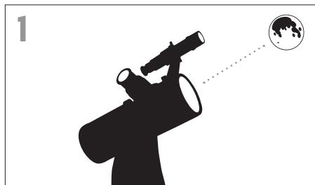
Lorsque la Lune est visible dans le ciel, installez votre télescope avec l'oculaire de 20 mm. Déplacez le télescope de manière qu'il pointe plus ou moins vers la Lune.
